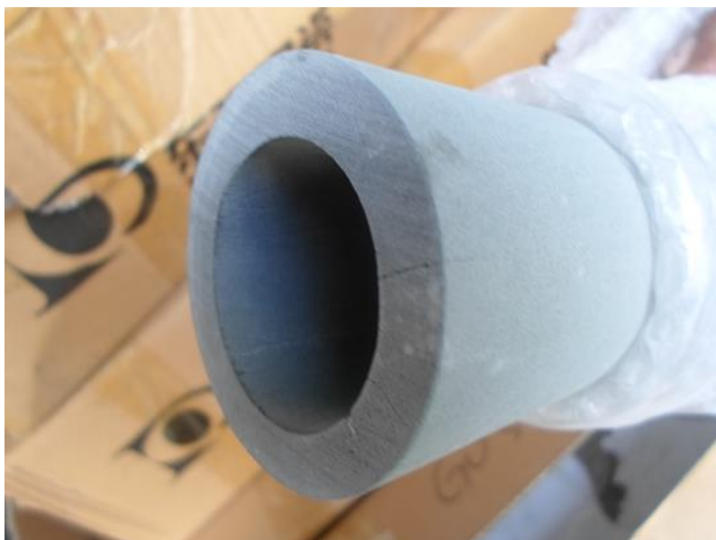
Figura 3. Fisuras en extremo de filtros
